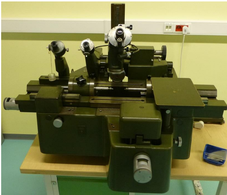
Widok stanowiska do optycznego pomiaru gwintów
