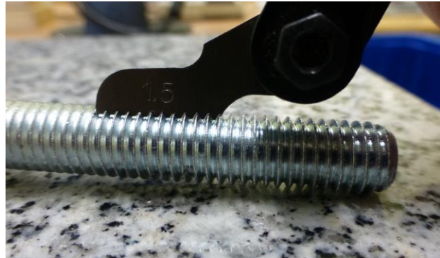
Ocena gwintu za pomocą wzornika zarysu
