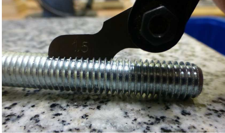
Ocena gwintu za pomocą wzornika zarysu
