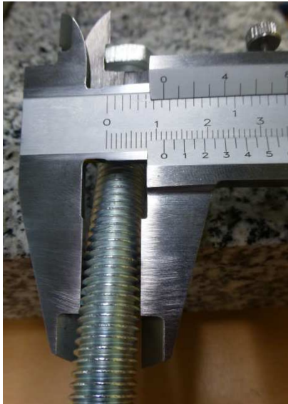
Pomiar wstępny średnicy zewnętrznej gwintu suwmiarką
