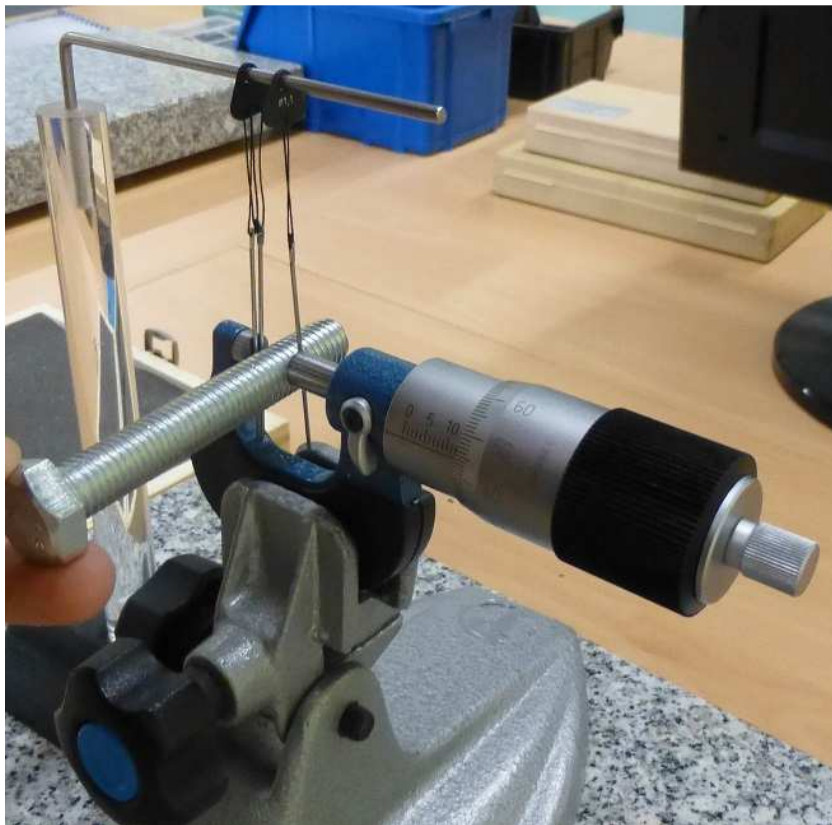
Wałeczek pomiarowy zawieszona na uchwycie oraz mikromierz umieszczony w statywie
