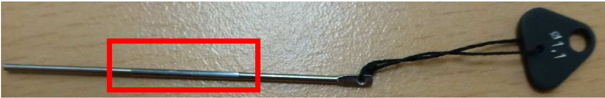
Wałeczek pomiarowy – środkowa część wałeczka charakteryzuje się wymiarem kontrolnym
