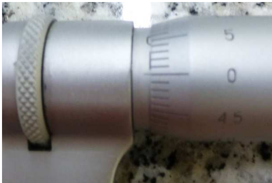
Zerowanie mikromierza do pomiaru średnicy podziałowej
