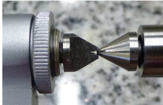
Zerowanie mikromierza do pomiaru średnicy podziałowej
