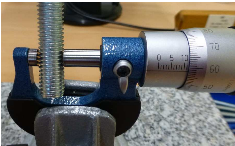
Pomiar średnicy zewnętrznej mikromierzem
