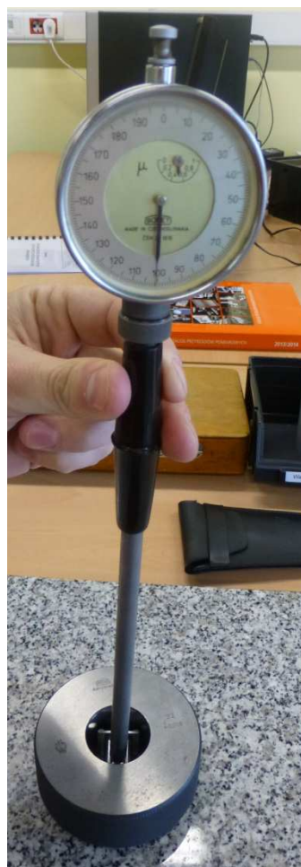
Średnicówka 2-punktowa (po lewej) i 3-punktowa (po prawej) w trakcie ustawiania na pierścieniu wzorcowym
